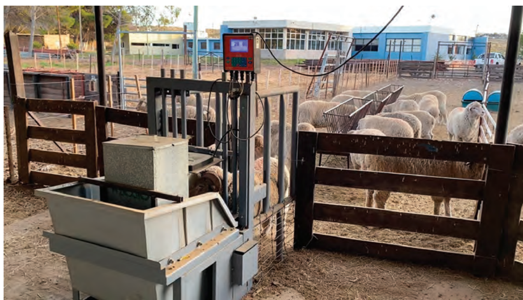
Imagen 4. Comederos inteligentes utilizados para evaluar el consumo residual.
