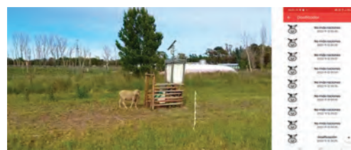
Imagen 5. Comederos de dosificación variable de alimento.
